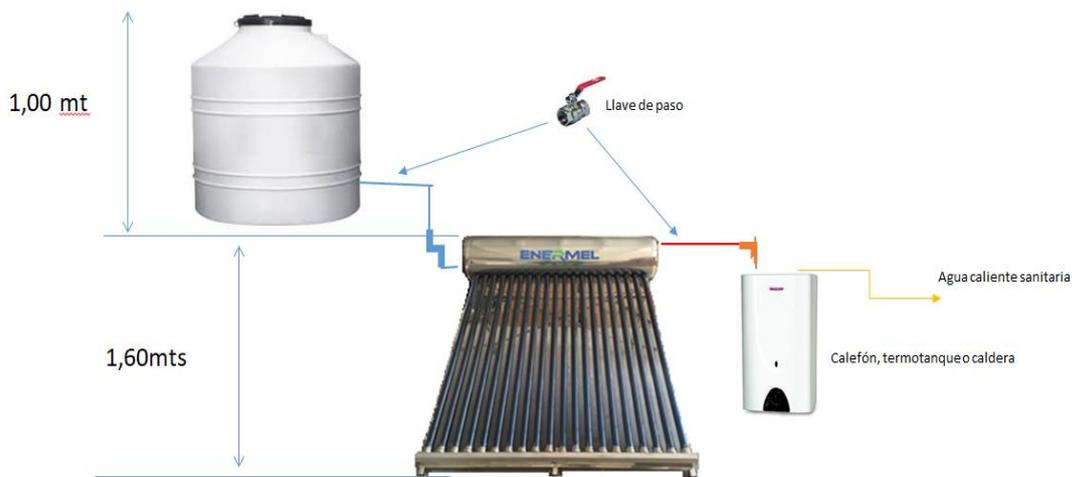
**Caso 2:** base del tanque de agua por debajo de 1,60mts (altura del termo solar)
