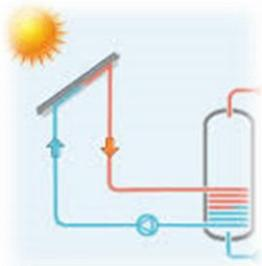
En el circuito primario de producción se hace circular un fluido caloportador (circulación forzada) el cual es utilizado para transferir la energía térmica a un boiler y de esta forma elevar la temperatura del agua dentro del mismo.
