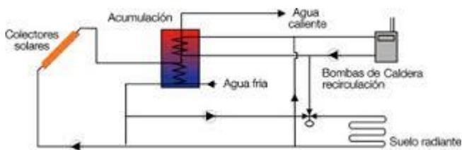
Para poder dimensionar el sistema adecuado de forma rápida es necesario conocer la cantidad de mts<sup>3</sup> a calefaccionar, sistema constructivo de la vivienda para determinar la perdida energética global (con poca aislación térmica, con media aislación térmica, con alto aislamiento térmico), la cantidad de personas que
