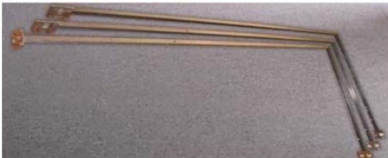
Usted notará que sólo una de las tres barras tiene orificios laterales. Se van a fijar juntos, esta fijación se compone de la parte central del marco derecho a la parte inferior del colector. Luego deberá colocar los refuerzos laterales como lo muestra la siguiente figura:
